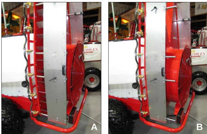
Rys. 24. Szczelina wylotowa deflektora: A – otwarta; B - zamknięta.
