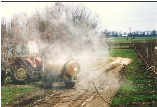
Rys. 25. Na uwrociach rozpylacze należy bezwzględnie wyłączyć
