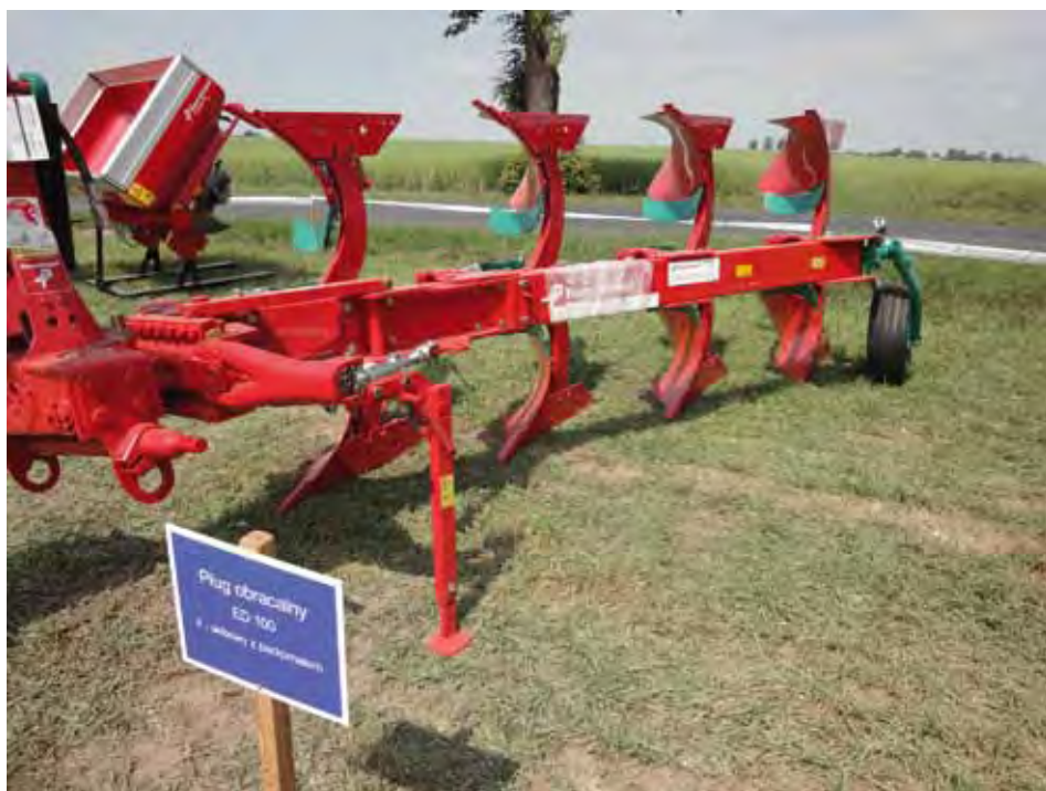
Fot. 3. Plug obracalny jest znacznie wydajniejszy od pługa zagonowego
