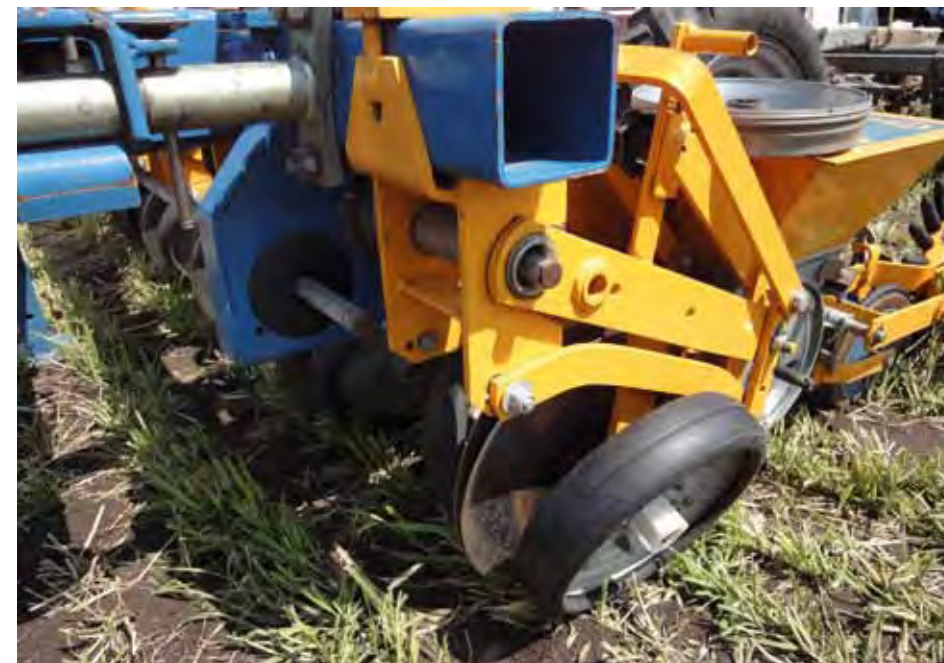
Fot. 5. Siewnik punktowy wyposażony w kroje tarczowe umożliwiające siew buraków w mulcz
