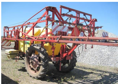
Fot. 73. Opryskiwacz z belką polową przystosowany do ochrony drzew alejowych w pierwszym okresie uprawy, zaopatrzony w korpusy rozpylaczy
