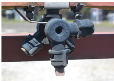
Fot. 74. Korpus rozpylaczy polowych montowanych na belce polowej
