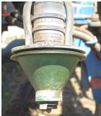
Fot. 72. Pojedynczy atomizer montowany na belce polowej opryskiwacza
