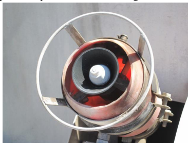
Fot. 70. Atomizer montowany przy wylocie oraz z boku rury wyprowadzającej strumień powietrza z wentylatora
