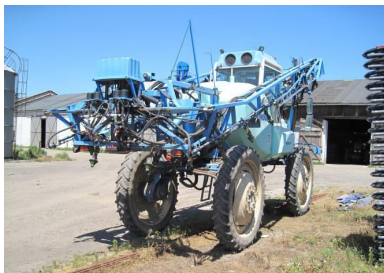
Fot. 71 Opryskiwacz z belką polową przystosowany do ochrony drzew alejowych w pierwszym okresie uprawy, zaopatrzony w atomizery rozmieszczone na belce
