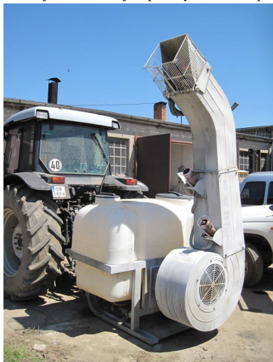
Fot. 69. Zbiornik opryskiwacza z wentylatorem oraz rurą dmuchawą, gdzie przy wylocie powietrza oraz z boku rury zamontowano atomizery
