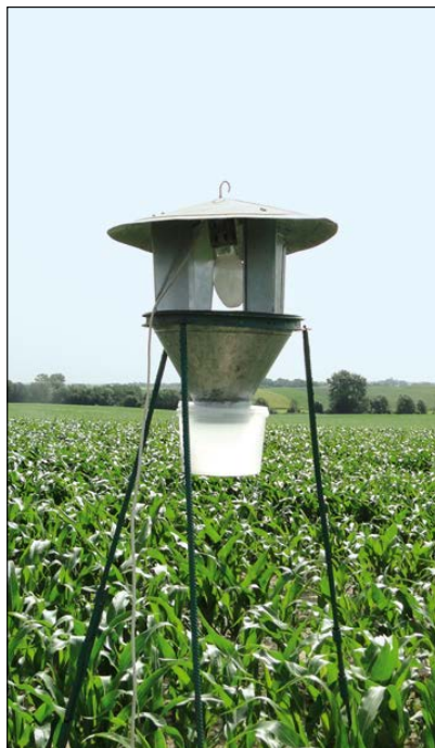
Fot. 7. Samołówka świetlna wabiąca owady za pomocą sztucznego światła (Fot. P. Beres)
