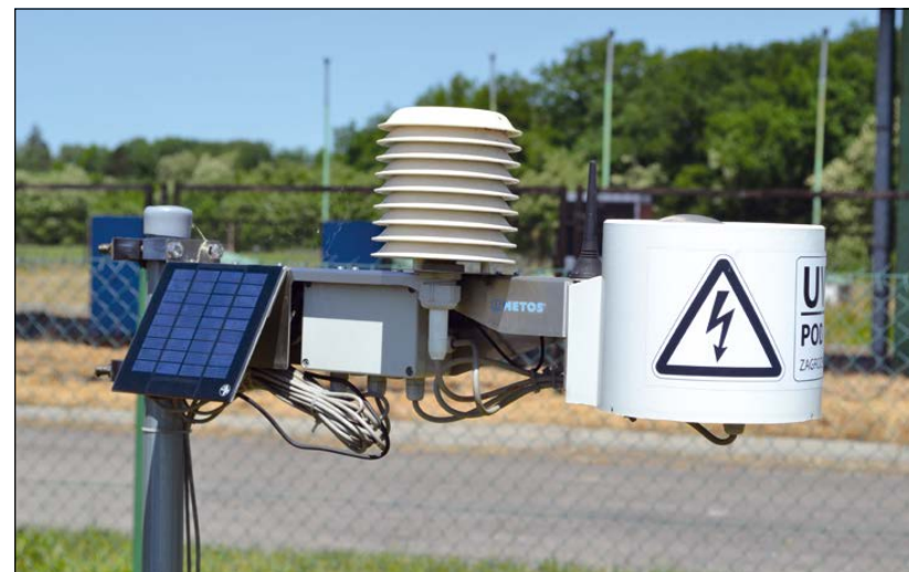
Fot. 9. Polowa stacja meteorologiczna na powierzchni rolnej (fot. M. Baran)
