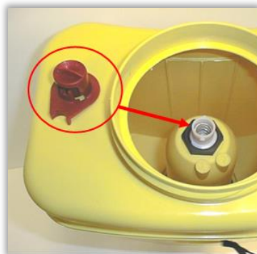
Rys. 15 Uszkodzony zawór upustowy na zbiorniku ciśnieniowym uniemożliwia uzyskanie i utrzymanie żądanego ciśnienia roboczego.
