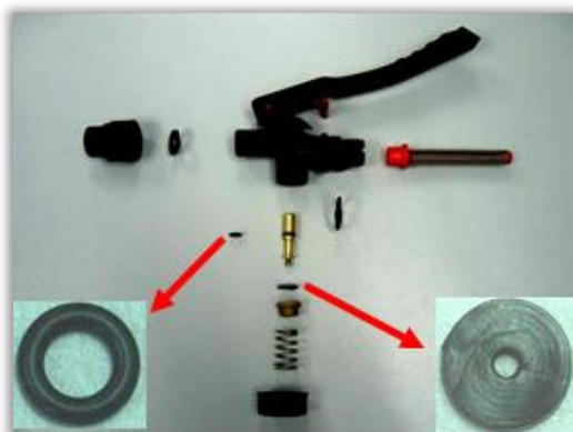
Rys. 9 Uszczelnienia elementów zaworu odcinającego w rękojeści lancy.
