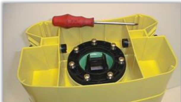
Rys. 13 Pierścień mocujący przeponę pompy opryskiwacza plecakowego.
