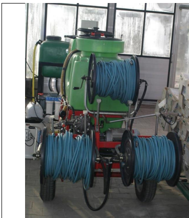
Fot. 36. Opryskiwacz ciśnieniowy posiadający 3 lance do opryskiwania
