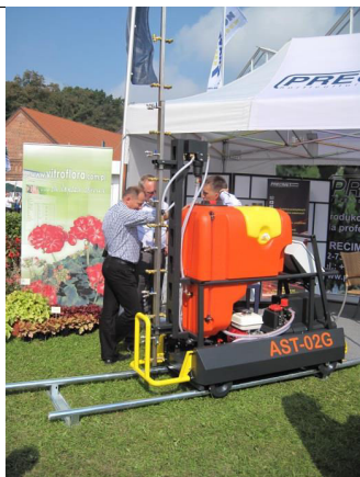
Fot. 37. Opryskiwacz szklarniowy poruszający się po drodze transportowej, zaopatrzony w pionową belkę opryskową
