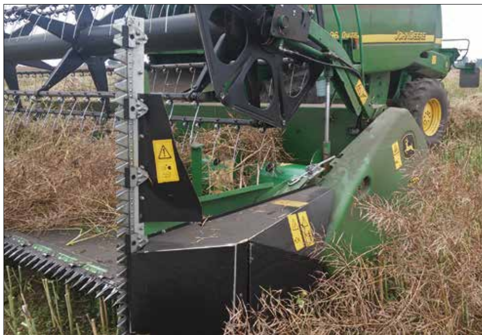
Fot. 59. Zespół żniwny John Deere 625R z wydłużoną podłogą i aktywnymi rozdzielaczami łanu (fot. J. Przybył)
