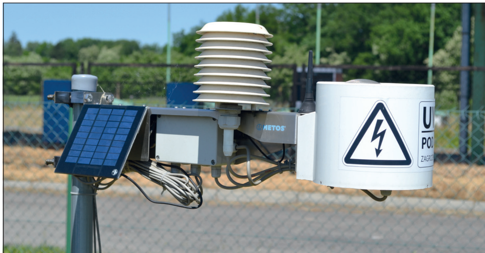
Fot. 9. Polowa stacja meteorologiczna na powierzchni rolnej (fot. M. Baran)
