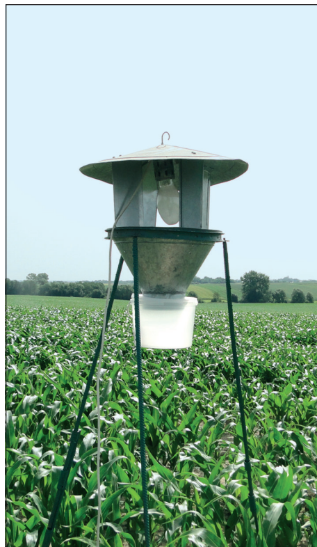
Fot. 7. Samolówka świetlna wabiąca owady za pomocą sztucznego światła (fot. P. Beres)
