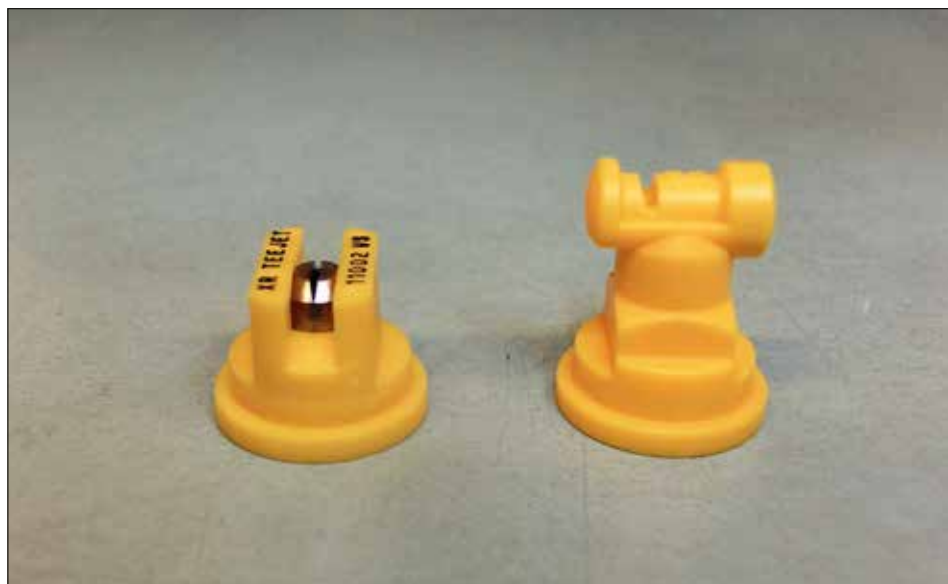
Fot. 23. Rozpylacze jednostrumieniowe rozmiar 02 (żółty): klasyczny (po lewej) i uderzeniowy (po prawej) różnią się charakterystyką wytworzonych kropli, gdy pracują pod tym samym ciśnieniem cieczy. Dla 0,3 MPa, pierwszy klasyfikowany jest jako drobnokroplisty, drugi średniokroplisty (fot. H. Ratajkiewicz)
