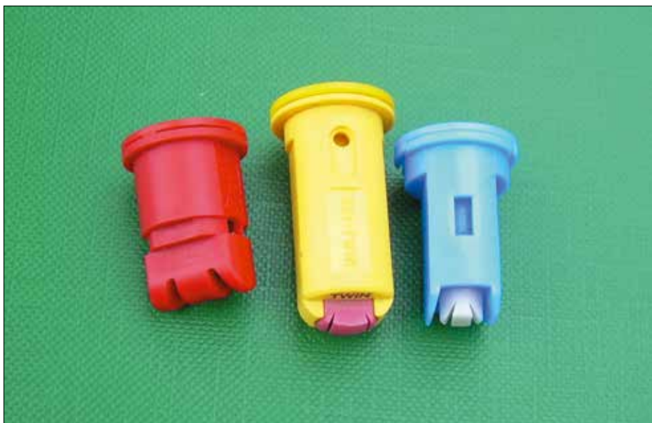
Fot. 26. Rozpylacze dwustrumieniowe eżektorowe w wersji z symetrycznymi wachlarzami (najczęściej tworzą względem siebie kąt 60° – jak na zdjęciu) (fot. R. Kierzek)
