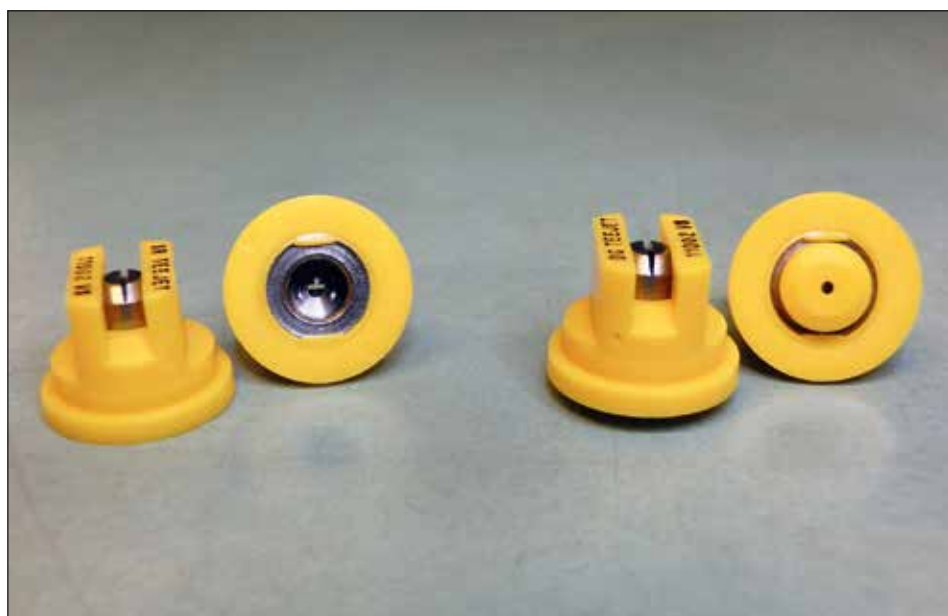
Fot. 24. Rozpylacz wyposażony w kryzę wstępną (po prawej) wytwarza krople większe i mniej podatne na znoszenie niż rozpylacz klasyczny (po lewej), mimo że ukształtowanie szczeliny wylotowej jest takie samo (fot. H. Ratajkiewicz)
