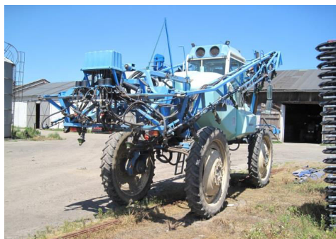
Fot. 86 Opryskiwacz z belką polową przystosowany do ochrony drzew alejowych w pierwszym okresie uprawy, zaopatrzony w atomizery rozmieszczone na belce
