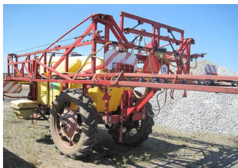
Fot. 89. Opryskiwacz z belką polową przystosowany do ochrony drzew alejowych w pierwszym okresie uprawy, zaopatrzony w korpusy rozpylaczy
