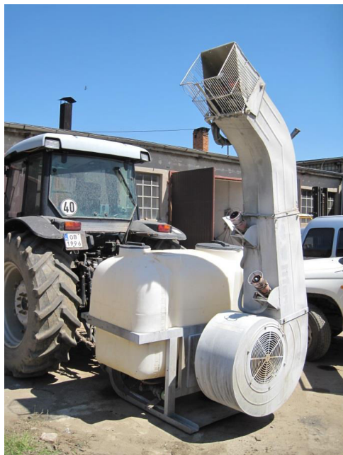
Fot. 84. Zbiornik opryskiwacza z wentylatorem oraz rurą dmuchawą, gdzie przy wylocie powietrza oraz z boku rury zamontowano atomizery
