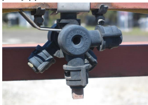
Fot.90. Korpus rozpylaczy polowych montowanych na belce polowej
