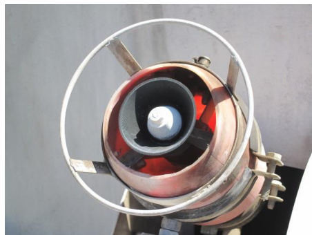
Fot. 85. Atomizer montowany przy wylocie oraz z boku rury wyprowadzającej strumień powietrza z wentylatora
