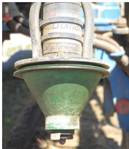
Fot. 87. Pojedynczy atomizer montowany na belce polowej opryskiwacza
