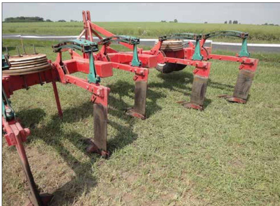
Fot. 3. Głębosz spulchnia warstwę podorną i orną gleby oraz poprawia stosunki powietrzno-wodne (fot. M. Nowakowski)
