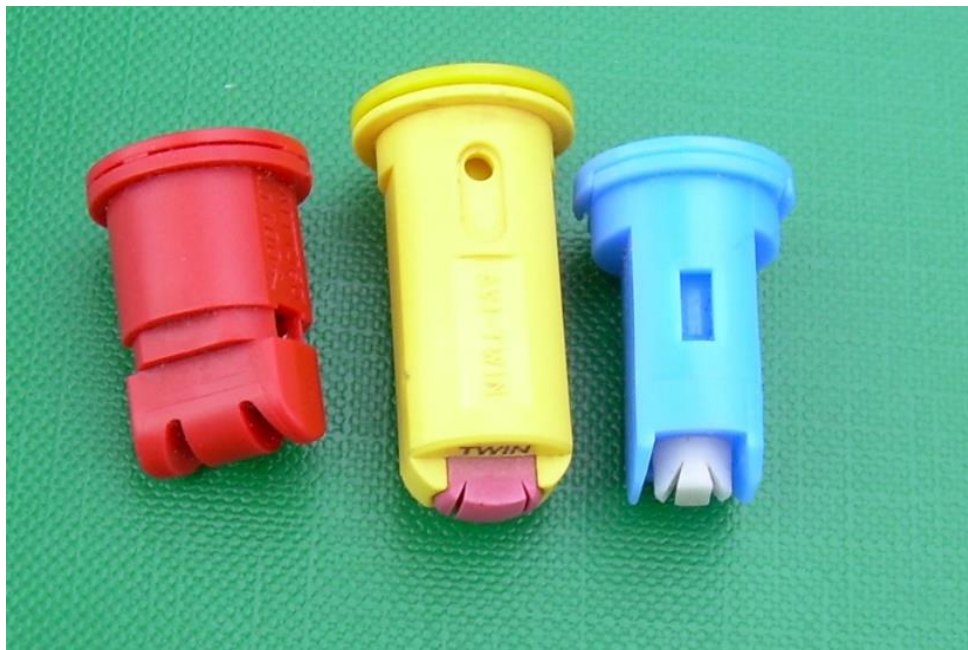
Fot. 79. Rozpylacze dwustrumieniowe eżektorowe w wersji z symetrycznymi wachlarzami (najczęściej tworzą względem siebie kąt 60^\circ – jak na zdjęciu) (fot. R. Kierzek)
