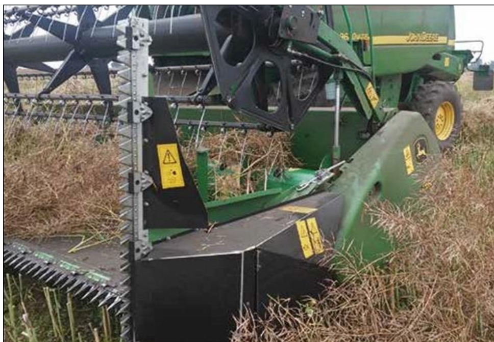
Fot. 77. Zespół żniwny John Deere 625R z wydłużoną podłogą i aktywnymi rozdzielaczami łanu (fot. J. Przybył)
