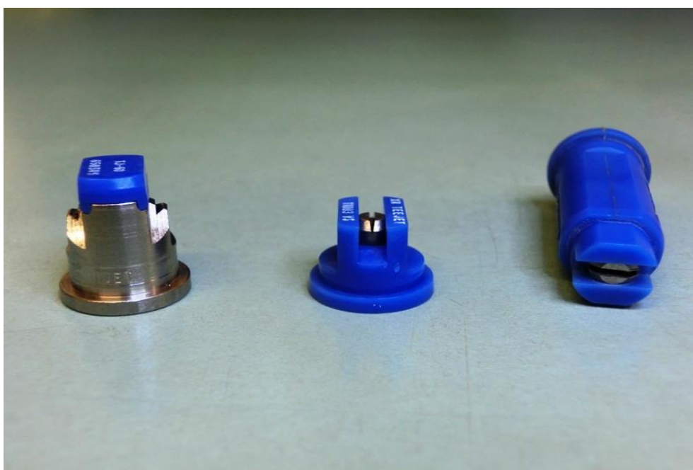
Fot. 78. Wielkość kropli wytwarzana przez rozpylacz o płaskim strumieniu zależy od jego konstrukcji. Przy tym samym wydatku i pod ciśnieniu 0,3 MPa rozpylacze przedstawione na zdjęciu klasyfikowane są następująco: bardzo drobnokroplisty – klasyczny rozpylacz dwustrumieniowy (po lewej), drobnokroplisty – standardowy rozpylacz jednostrumieniowy (w środku), bardzo grubokroplisty – rozpylacz eżektorowy (po prawej) (fot. H. Ratajkiewicz)
