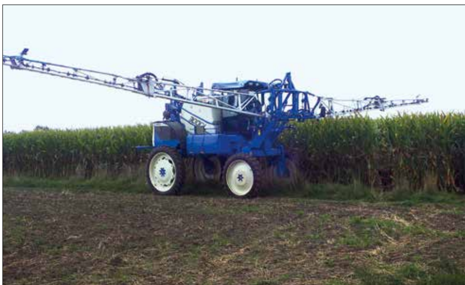
Fot. 65. Opryskiwacz szczudłowy do ochrony kukurydzy nie wymaga ścieżek technologicznych (fot. P. Beres)
