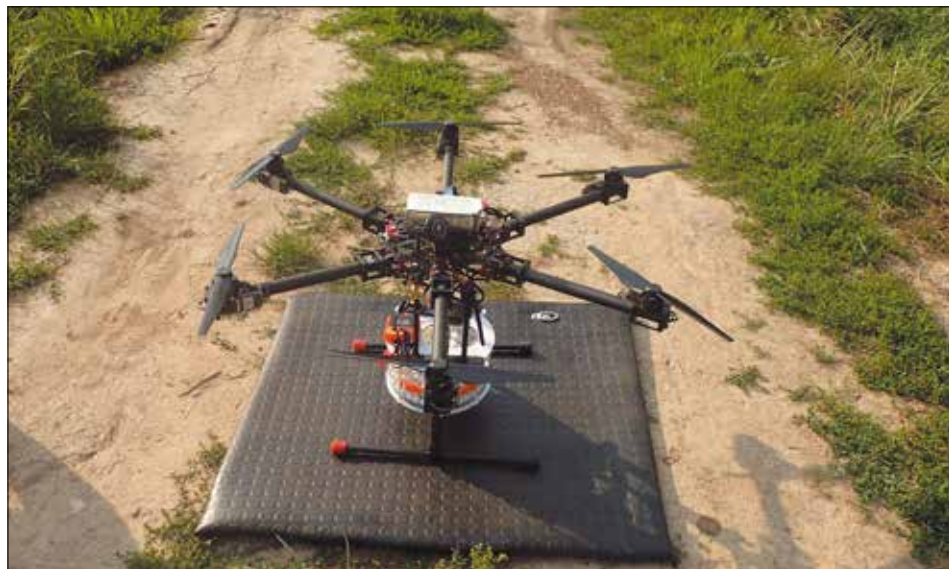
Fot. 58. Dron do aplikacji biopreparatu z kruszynkiem (fot. P. Bereś)
