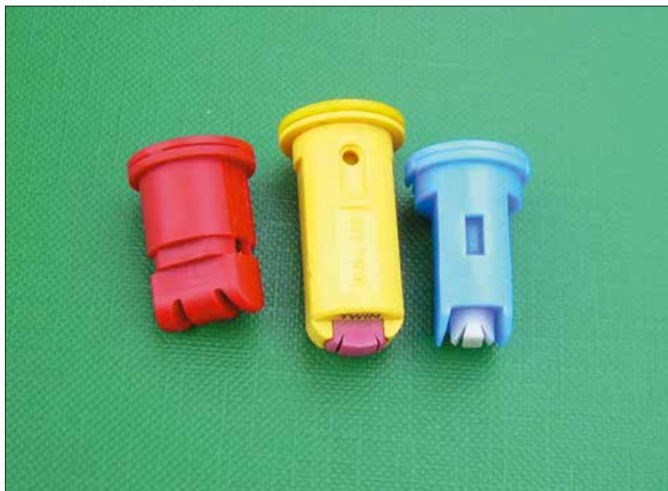
Fot. 52. Rozpylacze dwustrumieniowe eżektorowe w wersji z symetrycznymi wachlarzami (najczęściej tworzą względem siebie kąt 60^\circ – jak na zdjęciu) (fot. R. Kierzek)
