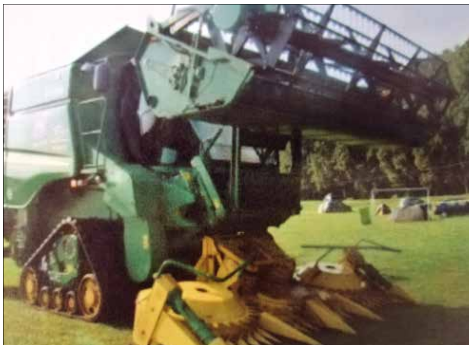
Fot. 50. Zbiór konopi samobieżnym kombajnem oraz zbiór połączony z odcinaniem wiech i omłotem po dosuszeniu (fot. R. Kaniewski)
