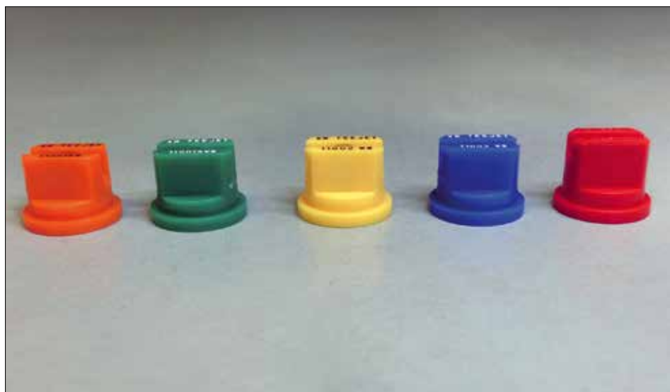
Fot. 53. Zgodnie z normami ISO kolor rozpylacza koduje jego wydajność cieczy w ciągu 1 minuty. Rozpylacze o większym wypływie cieczy wytwarzają krople o większych rozmiarach, gdy pracują pod tym samym ciśnieniem. Od lewej rozmiar: 01, 015; 02; 03 i 04 (fot. H. Ratajkiewicz)
