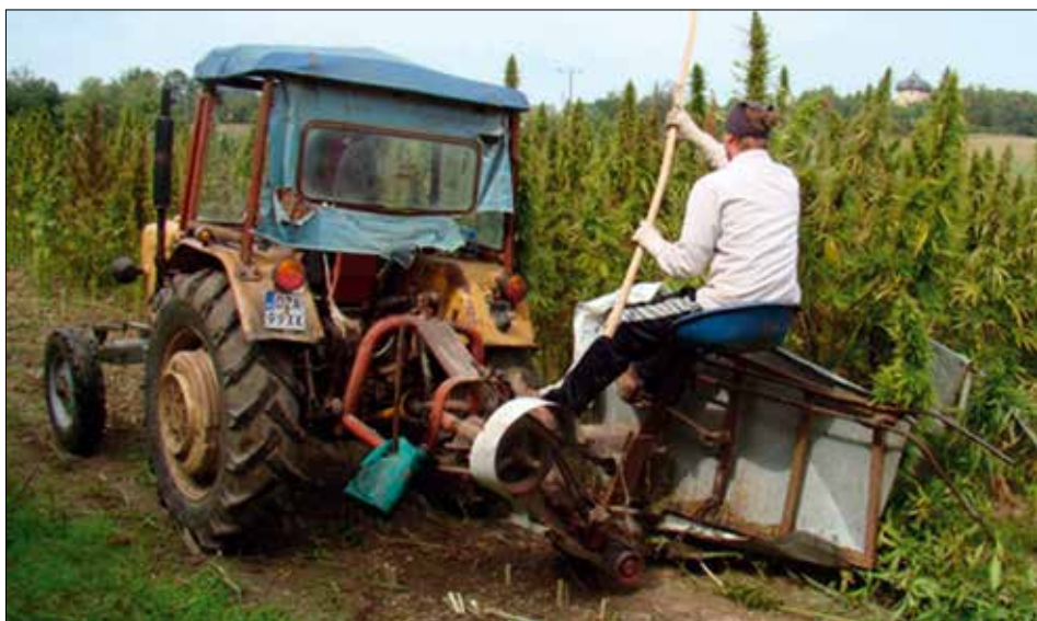
Fot. 45. Koszenie konopi przy użyciu typowej, zaczepianej kosiarki palcowej – zbiór dwufazowy (fot. R. Kaniewski)
