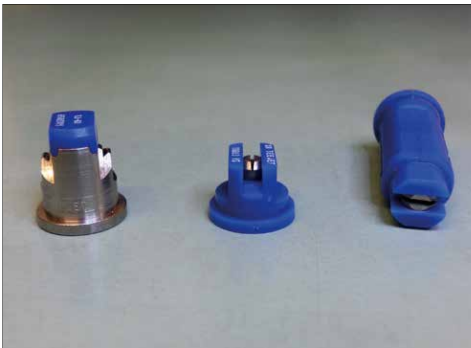
Fot. 54. Wielkość kropli wytwarzana przez rozpylacz o płaskim strumieniu zależy od jego konstrukcji. Przy tym samym wydatku i pod ciśnieniem 0,3 MPa rozpylacze przedstawione na zdjęciu (rozmiar 03 – niebieski) klasyfikowane są następująco: bardzo drobnokroplisty – standardowy rozpylacz dwustrumieniowy (po lewej), drobnokroplisty – klasyczny rozpylacz jednostrumieniowy (w środku), bardzo grubokroplisty – rozpylacz eżektorowy (po prawej) (fot. H. Ratajkiewicz)
