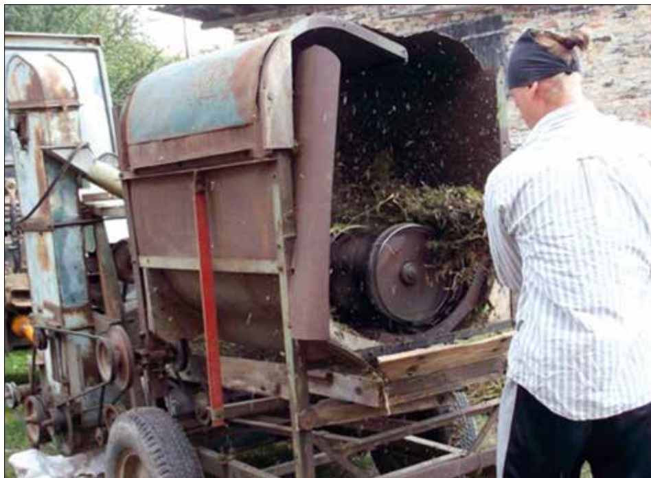
Fot. 47. Odziarnianie konopi po dojrzewaniu nasion na polu przy zbiorze dwufazowym (fot. R. Kaniewski)
