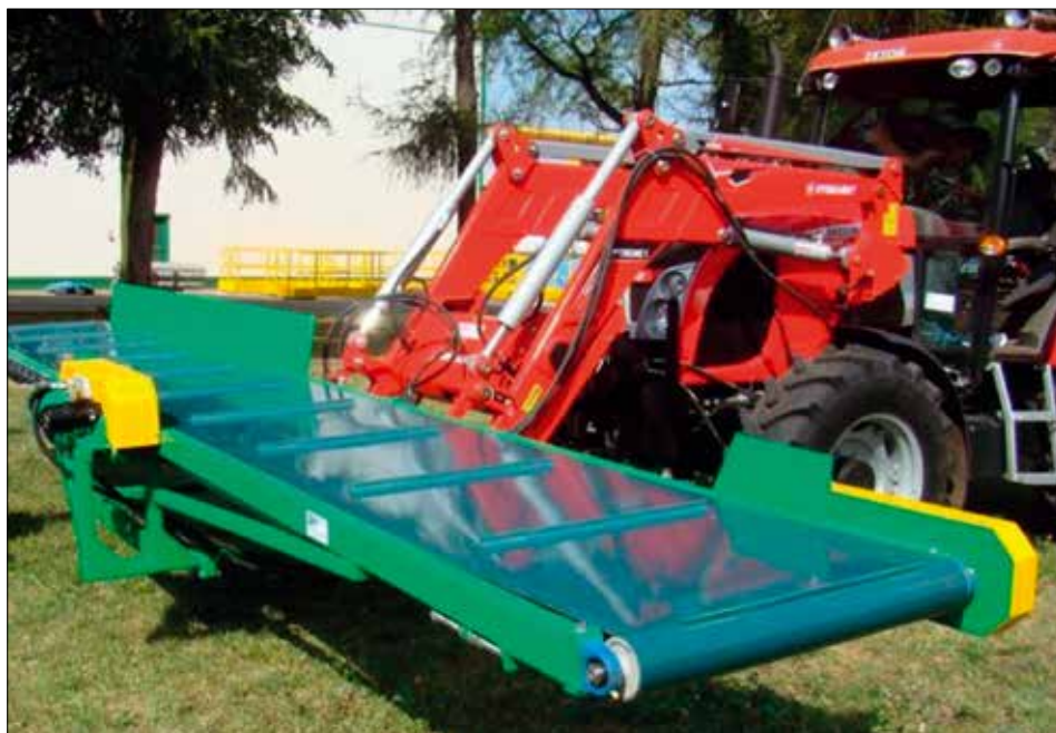
Fot. 51. Zawieszana na ładowaczu czołowym kosiarka wiech konopnych (fot. R. Kaniewski)
