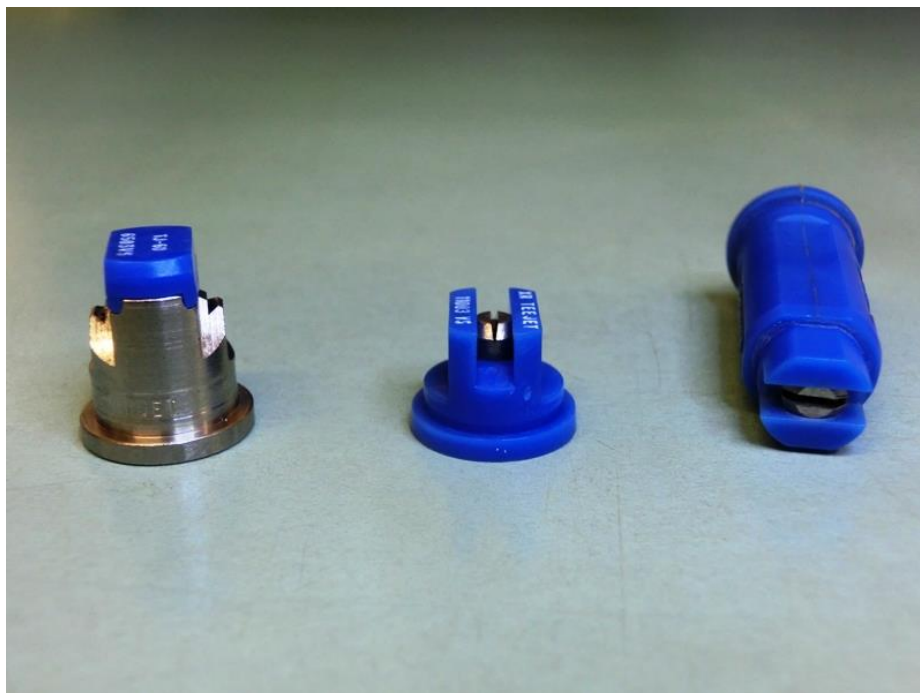
Fot. 62. Wielkość kropli wytwarzana przez rozpylacz o płaskim strumieniu zależy od jego konstrukcji. Przy tym samym wydatku i pod ciśnieniem 0,3 MPa rozpylacze przedstawione na zdjęciu klasyfikowane są następująco: bardzo drobnokroplisty – klasyczny rozpylacz dwustrumieniowy (po lewej), drobnokroplisty – klasyczny rozpylacz jednostrumieniowy (w środku), bardzo grubokroplisty – rozpylacz eżektorowy (po prawej) (fot. H. Ratajkiewicz)
