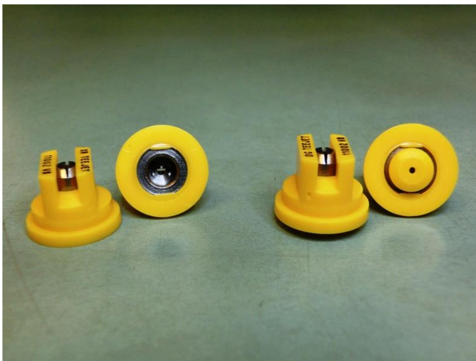
Fot. 64. Rozpylacz wyposażony w kryzę wstępną (po prawej) wytwarza krople większe i mniej podatne na znoszenie niż rozpylacz klasyczny (po lewej), mimo że ukształtowanie szczeliny wylotowej jest takie same (fot. H. Ratajkiewicz)
