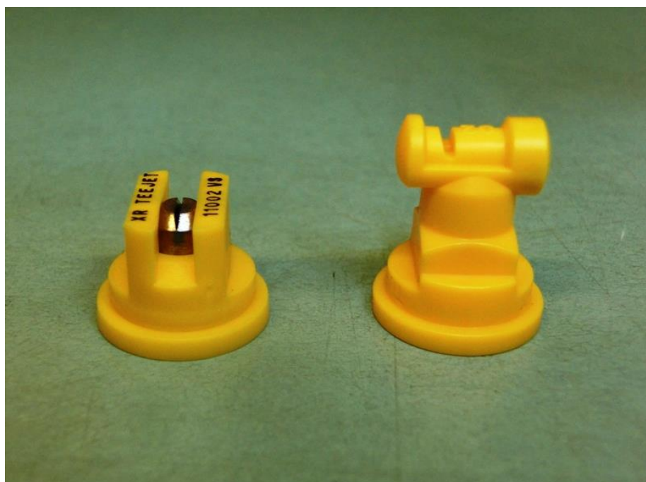
Fot. 63. Rozpylacze jednostrumieniowe rozmiar 02 (żółty): klasyczny (po lewej) i uderzeniowy (po prawej) różnią się charakterystyką wytworzonych kropli, gdy pracują pod tym samym ciśnieniem cieczy. Dla 0,3 MPa, pierwszy klasyfikowany jest jako drobnokroplisty, drugi średniokroplisty (fot. H. Ratajkiewicz)
