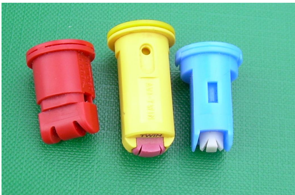
Fot. 66. Rozpylacze dwustrumieniowe eżektorowe w wersji z symetrycznymi wachlarzami (najczęściej tworzą względem siebie kąt 60° – jak na zdjęciu) (fot. R. Kierzek)
