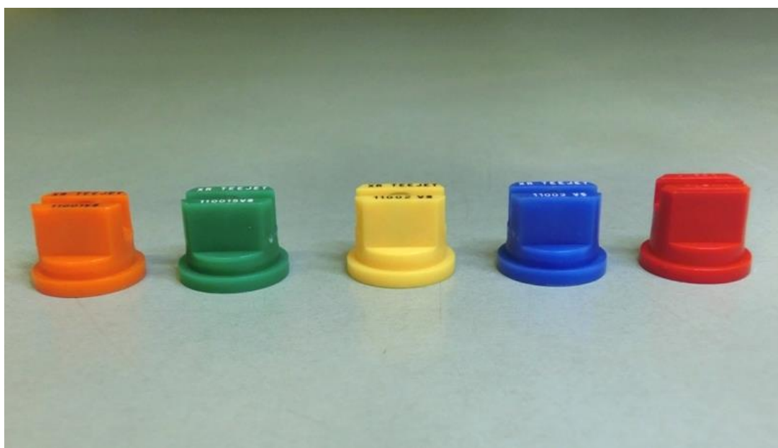
Fot. 61. Zgodnie z normami ISO kolor rozpylacza koduje jego wydajność cieczy w ciągu 1 minuty. Rozpylacze o większym wypływie cieczy wytwarzają krople o większych rozmiarach, gdy pracują pod tym samym ciśnieniem. Od lewej rozmiar: 01; 015; 02; 03 i 04 (fot. H. Ratajkiewicz)
