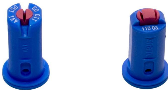
Fot. 49. Rozpylacze eżektorowe w rozmiarze 03 (niebieski): jednostrumieniowy (z lewej) i w wersji dwustrumieniowej (po prawej). Wkładki rozpylające wykonane z ceramiki (materiał bardzo trwały, odporny na rozkalibrowanie) (Fot. R. Kierzek)
