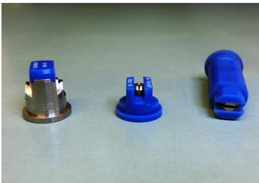
Fot. 48. Wielkość kropli wytwarzana przez rozpylacz o płaskim strumieniu zależy od jego konstrukcji. Przy tym samym wydatku i pod ciśnieniem 0,3 MPa rozpylacze przedstawione na zdjęciu klasyfikowane są następująco: bardzo drobnokroplisty – klasyczny rozpylacz dwustrumieniowy (po lewej), drobnokroplisty – standardowy rozpylacz jednostrumieniowy (w środku), bardzo grubokroplisty – rozpylacz eżektorowy (po prawej) (Fot. H. Ratajkiewicz).
