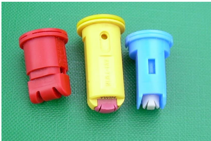
Fot. 50. Rozpylacze dwustrumieniowe eżektorowe (różnych producentów) w wersji z symetrycznymi wachlarzami (kąt pomiędzy strumieniami wynosi 60^\circ —kierunek przód/tył –jak na zdjęciu) (Fot. R. Kierzek)
