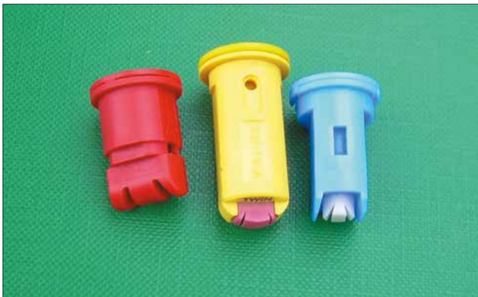
Fot. 82. Rozpylacze dwustrumieniowe eżektorowe w wersji z symetrycznymi wachlarzami (najczęściej tworzą względem siebie kąt 60^\circ – jak na zdjęciu) (fot. R. Kierzek)
