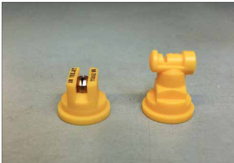
Fot. 79. Rozpylacz jednostrumieniowy rozmiar 02 (żółty): klasyczny (po lewej) i uderzeniowy (po prawej) różnią się charakterystyką wytworzonych kropli, gdy pracują pod tym samym ciśnieniu cieczy. Dla 0,3 MPa, pierwszy klasyfikowany jest jako drobnokroplisty, drugi średniokroplisty (fot. H. Ratajkiewicz)
