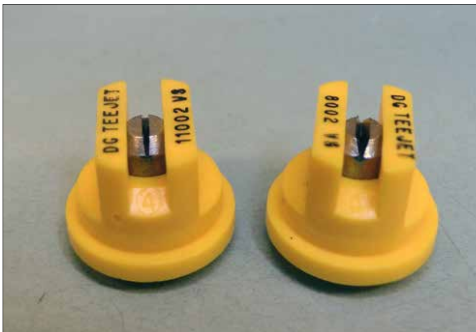
Fot. 81. Rozpylacze różniące się kątem strumienia kropli, 110^\circ (po lewej) i 80^\circ (po prawej) różnią się ukształtowaniem (szerokością) szczeliny wylotowej, co skutkuje wytwarzaniem nieco większych kropli przez rozpylacz o węższym strumieniu (fot. H. Ratajkiewicz)
