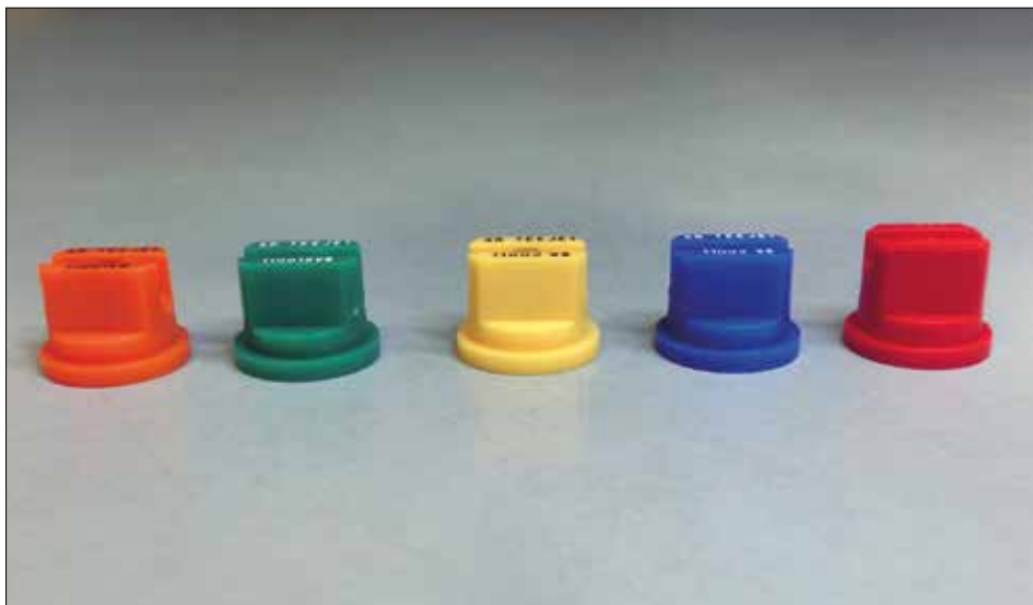
Fot. 77. Zgodnie z normami ISO kolor rozpylacza koduje jego wydajność cieczy w ciągu 1 minuty. Rozpylacze o większym wypływie cieczy wytwarzają krople o większych rozmiarach, gdy pracują pod tym samym ciśnieniem. Od lewej rozmiar: 01; 015; 02; 03 i 04 (fot. H. Ratajkiewicz)
