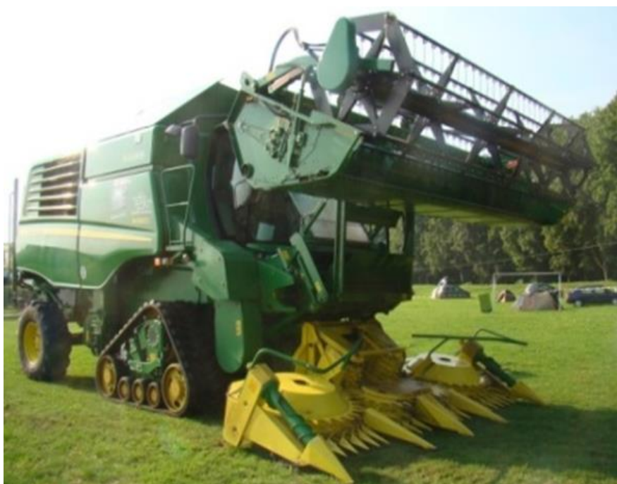
Fot. 23. Zbiór konopi samobieżnym kombajnem oraz zbiór połączony z odcinaniem wiech i omłotem po dosuszeniu
