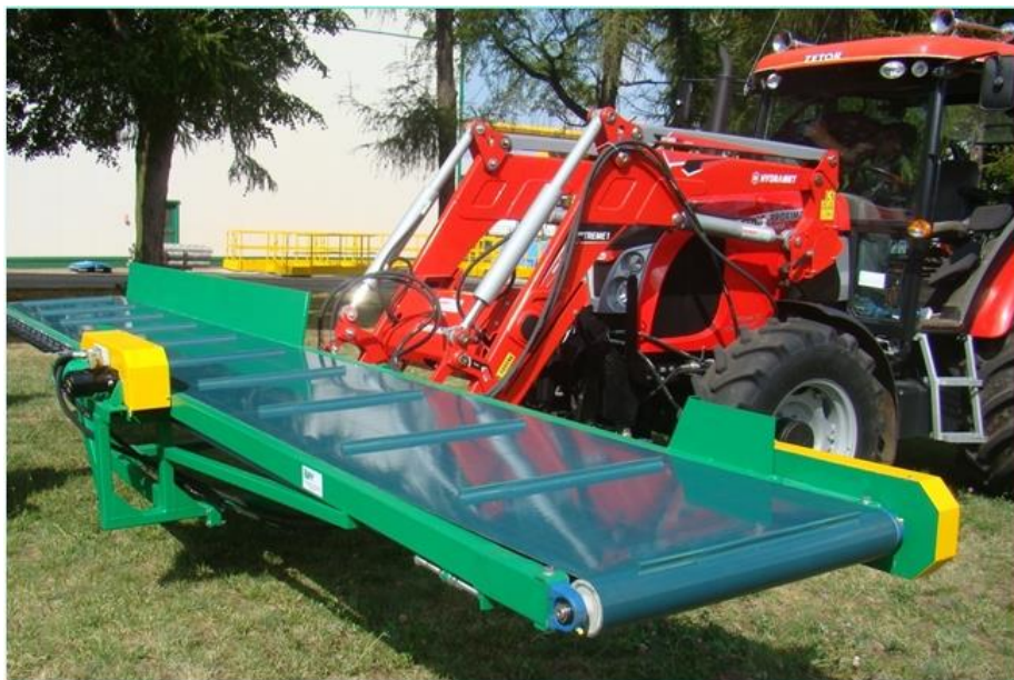
Fot.24. Zawieszana na ładowaczu czołowym kosiarka wiech konopnych
