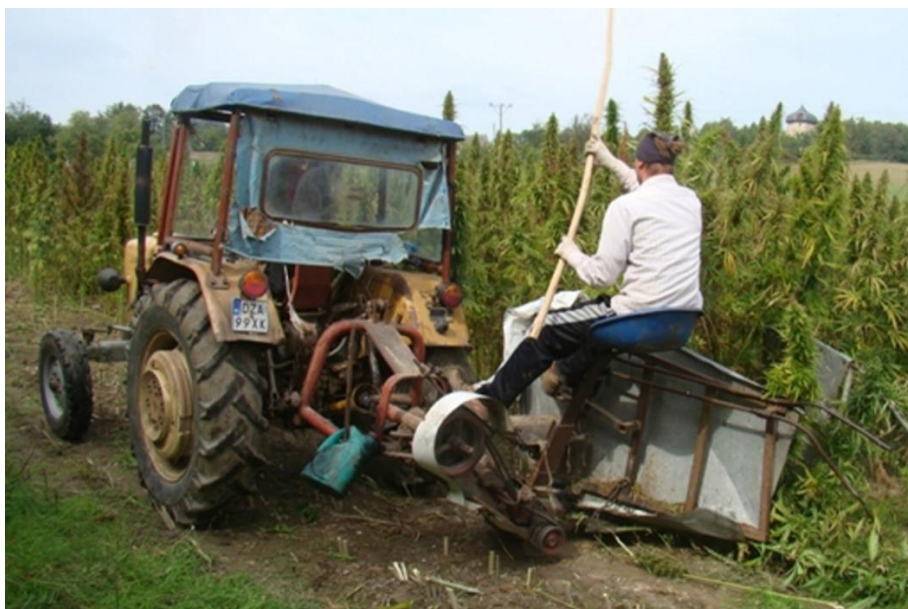
Fot. 18. Koszenie konopi przy użyciu typowej, zaczepianej kosiarki palcowej – zbiór dwufazowy
