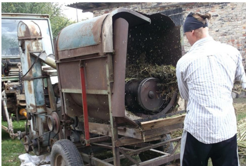
Fot. 20. Odziarnianie konopi po dojrzeniu nasion na polu przy zbiorze dwufazowym
