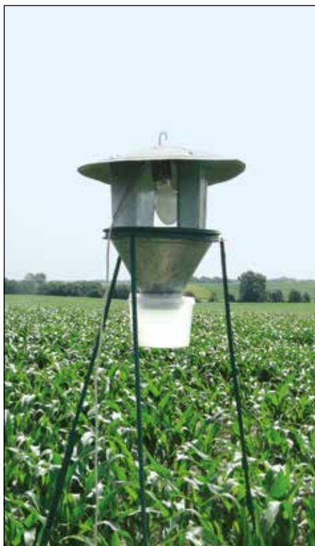
Fot. 7 Samolówka świetlna wabiąca owady za pomocą sztucznego światła (fot. P. Bereś)
