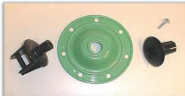
Rys. 12 Przepona pompy dźwigniowego opryskiwacza plecakowego.
