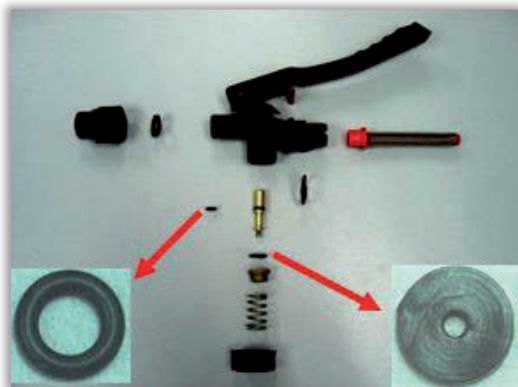
Rys. 9 Uszczelnienia elementów zaworu odcinającego w rękojeści lancy.
