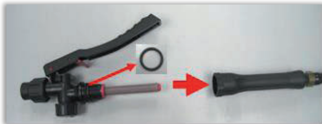
Rys. 10 Uszczelnienie gniazda filtra w rękojeści lancy opryskiwacza plecakowego.
