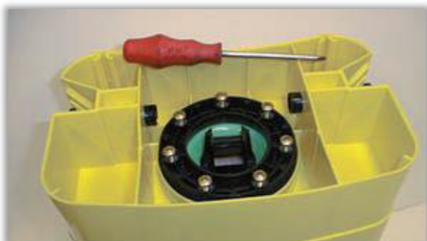
Rys. 13 Pierścień mocujący przeponę pompy opryskiwacza plecakowego.
