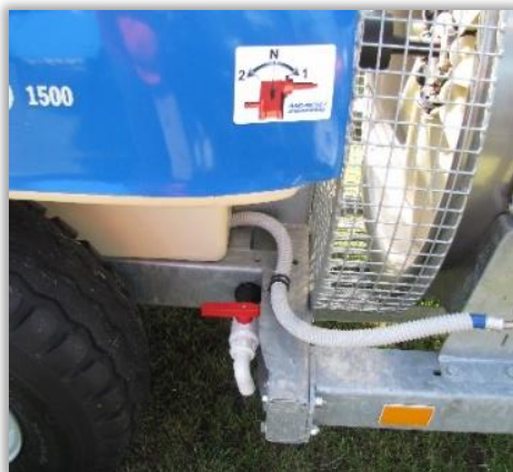
Rys. 105. Zawór spustowy opryskiwacza.
