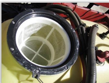
Rys. 28. Sito wlewowe bez rozwadniacza preparatów.
