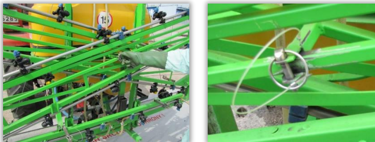
Rys. 66 i 67. Złożona belka polowa i sworzeń zabezpieczający ją przed niekontrolowanym rozłożeniem się.
