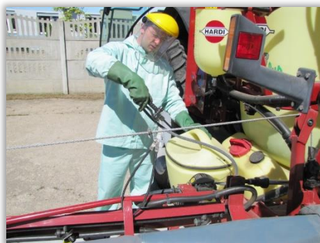
Rys. 45. Płukanie wnętrza rozwadniacza za pomocą specjalnej lancy.
