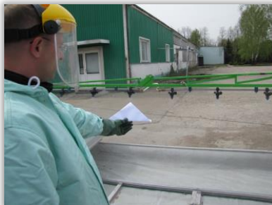
Rys. 73. Ocena kąta rozpylania z wykorzystaniem papierowego wzorca.
