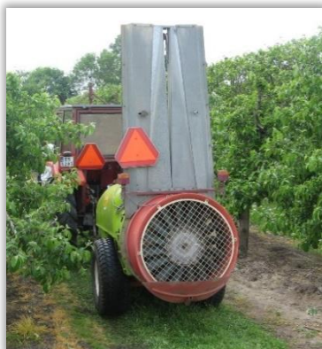
Rys. 128 i 129. Opryskiwacz z wentylatorem promieniowym (128) z indywidualnie kierowanymi strumieniami powietrza oraz z wentylatorem osiowym z deflektorem (129).
