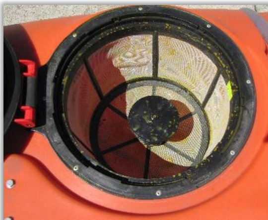
Rys. 109. Rozwadniacz środków ochrony w sicie wlewowym opryskiwacza.
