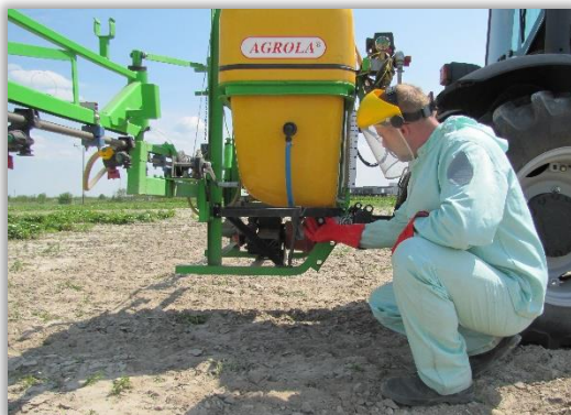
Rys. 12. Sprawdzenie szczelności zaworu spustowego opryskiwacza polowego.
