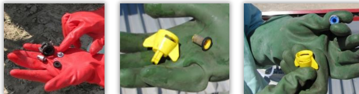
Rys. 75-77. Filtry rozpylaczy: typ 1 (75), typ 2, rozmiar 1 (76), typ 2, rozmiar 2.
