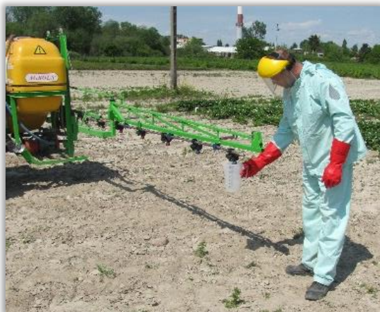
Rys. 80. Pomiar natężenia wypływu cieczy z rozpylaczy wybranych sekcji.
