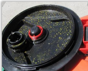
Rys. 26. Zawór napowietrzający pokrywy zbiornika.
