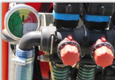
Rys. 114 i 115. Regulacje zaworów kompensacyjnych opryskiwacza sadowniczego z oznaczeniem pozycji ustawienia zaworu.
