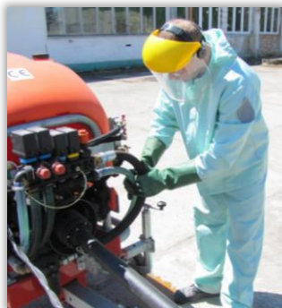
Rys. 116. Sprawdzanie jakości połączeń układu cieczowego w opryskiwaczu sadowniczym.
