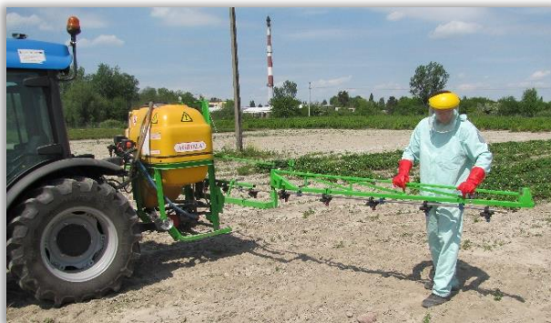
Rys. 71. Test układu amortyzacji i stabilizacji belki połowej.
