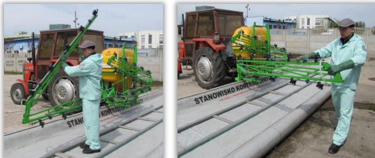
Rys. 63 i 64. Test ręcznego składania - rozkładania belki polowej.
