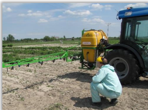
Rys. 79. Wizualna ocena strumienia cieczy z pojedynczych rozpylaczy.
