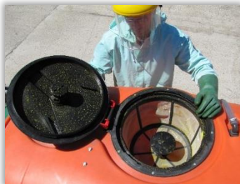
Rys. 98 i 99. Pokrywa zbiornika opryskiwacza sadowniczego zamocowana za pomocą zawiasu.
