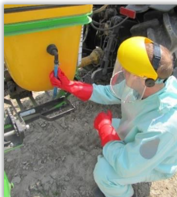
Rys. 11. Sprawdzenie szczelności połączeń przewodów cieczowych ze zbiornikiem.
