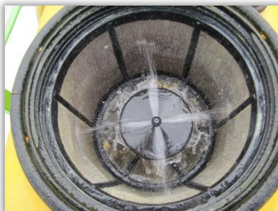
Rys. 39. Rozwadniacz zamontowany w sicie wlewowym zbiornika opryskiwacza.
