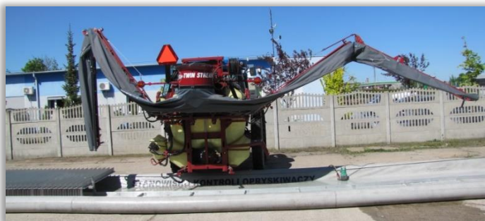
Rys. 65. Test automatycznego składania - rozkładania belki polowej.
