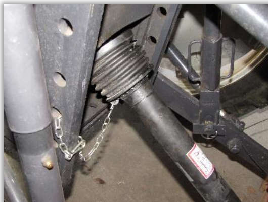
Rys. 4. Sposób zabezpieczenia osłony wałka przed obracaniem.
