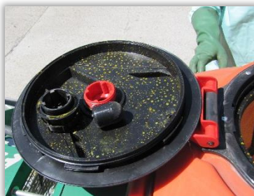
Rys. 100 i 101. Pokrywa zbiornika opryskiwacza z systemem napowietrzającym.
