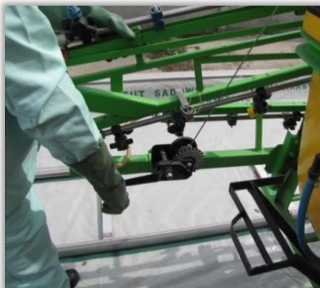
Rys. 68. Wyciągarka ręcznej regulacji wysokości belki polowej.
