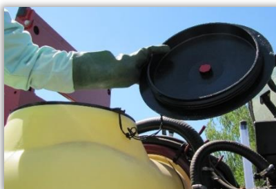
Rys. 22 i 23. Mocowanie pokrywy na zawiasie (22) i linką (23).
