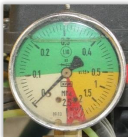
Rys. 49. Manometr zalecany do pracy w zakresie do 5 barów (0,5 MPa) z prawidłową działką elementarną – skala w MPa.
