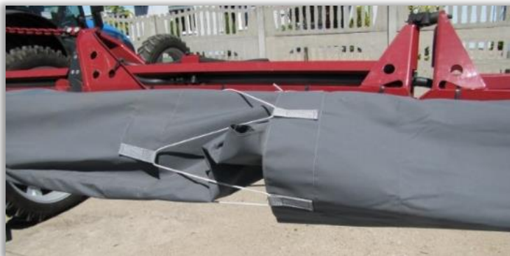
Rys. 84. Rękaw opryskiwacza polowego PSP - sposób ułożenia się rękawa.
