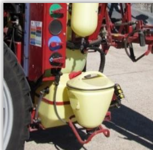
Rys. 39. Rozwadniacz zamontowany w sicie wlewowym zbiornika opryskiwacza.
