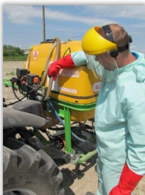
Rys. 7. Sprawdzenie przewodów cieczowych opryskiwacza.
