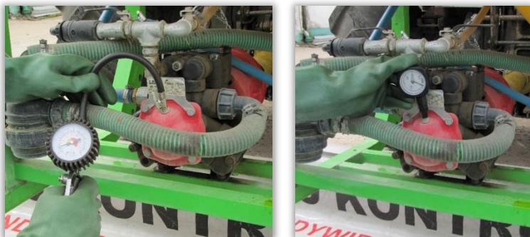
Rys. 18 i 19. Sprawdzenie ciśnienia w powietrzniku za pomocą manometru na przewodzie ciśnieniowym pompki lub sprężarki (18) i prostym ciśnieniomierzem.
