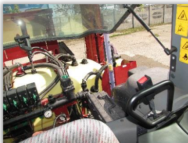
Rys. 31. Wskaźnik poziomu cieczy „mokry” widoczny dla operatora.
