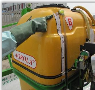
Rys. 20. Mieszadło hydrauliczne i przewód powrotny do zbiornika.
