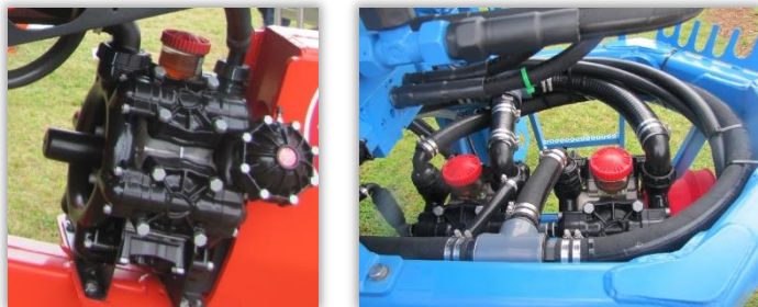
Rys. 16 i 17. Zbiornik wskaźnikowy poziomu oleju w pompie opryskiwacza (16) i pompy zespolone – każda z osobnym zbiornikiem (17).
