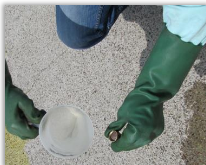
Rys. 125. Przepłukiwanie zaworu przeciwkroplowego.
