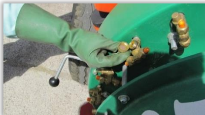
Rys. 123. Gniazdo zdemontowanego zaworu przeciwkroplowego.
