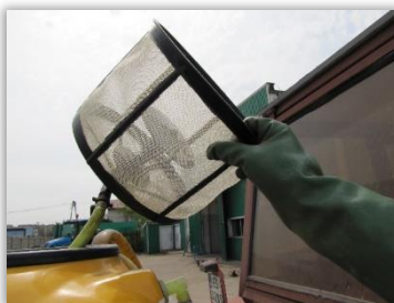
Rys. 28. Sito wlewowe bez rozwadniacza preparatów.
