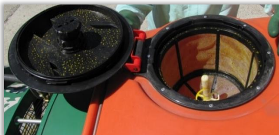
Rys. 110. Płuczka opakowań po środkach ochrony montowana we wnętrzu zbiornika opryskiwacza.
