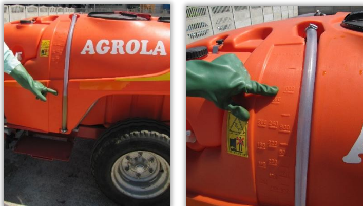
Rys. 103 i 104. Wskaźnik poziomu cieczy - "mokry".
