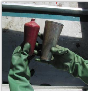
Rys. 60 i 61. Kontrola stanu technicznego i parametrów wkładu filtracyjnego.
