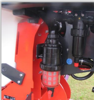
Rys. 59. Filtr z przezroczystą obudową umożliwiającą kontrolę stanu technicznego wkładu filtra.
