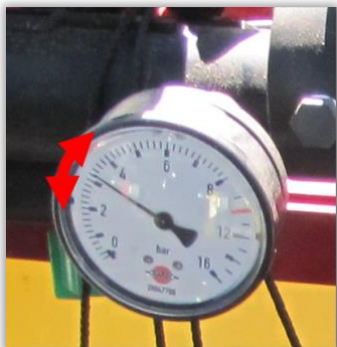
Rys. 53. Manometr z zaznaczonym zakresem drgań wskazówki.
