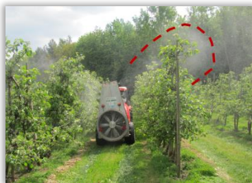
Rys. 132 i 133. Wydajność strumienia powietrza PRAWIDŁOWO dobrana – strumień dociera tylko do połowy sąsiedniego międzyrzędzia (132) i NIEPRAWIDŁOWO dobrana - dociera dalej niż do sąsiedniego rzędu (133).
