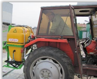
Rys. 31. Wskaźnik poziomu cieczy „mokry” widoczny dla operatora.
