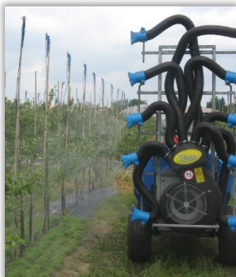
Rys. 128 i 129. Opryskiwacz z wentylatorem promieniowym (128) z indywidualnie kierowanymi strumieniami powietrza oraz z wentylatorem osiowym z deflektorem (129).
