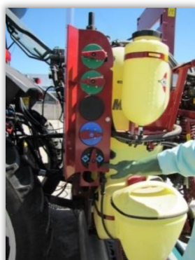
Rys. 33. Zawór spustowy opryskiwacza polowego.
