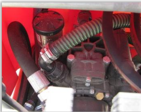
Rys. 95. Zbiornik wyrównawczy oleju w pompie opryskiwacza.
