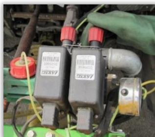
Rys. 114 i 115. Regulacje zaworów kompensacyjnych opryskiwacza sadowniczego z oznaczeniem pozycji ustawienia zaworu.
