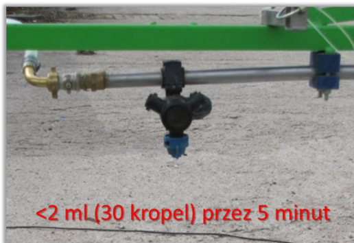
Rys. 72. Zawór przeciwkroplowy i dopuszczalny limit wycieku / kapania.
