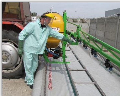
Rys. 6. Bezpieczna pozycja operatora przy sprawdzaniu pewności zawieszenia opryskiwacza.
