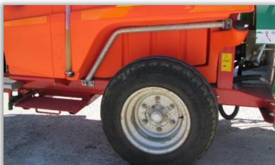
Rys. 108. Dodatkowy zbiornik na wodę do płukania układu cieczowego.
