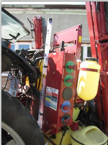
Rys. 30. Wskaźnik poziomu cieczy - "suchy".
