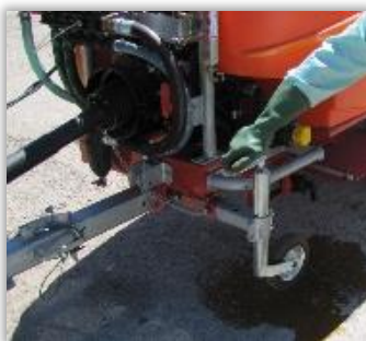
Rys. 88 i 89. Koło jezdne (88) i koło podporowe opryskiwacza sadowniczego.
