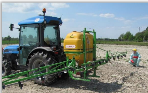
Rys. 69. Wizualna ocena wygięcia belki w płaszczyźnie poziomej.
