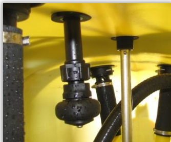
Rys. 35. Zraszacz do płukania wnętrza zbiornika.
