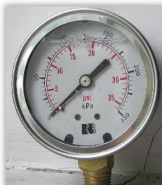
Rys. 51. Manometr ze zbyt małym zakresem pomiarowym (do 250 kPa / 2,5 bar) - skala w kPa i psi (funty na cal kwadratowy).
