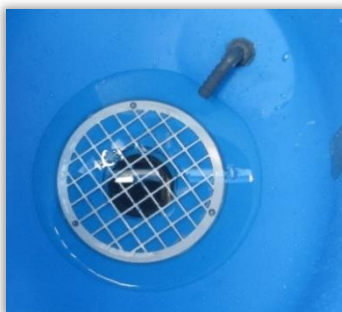
Rys. 43 i 44. Sito we wnętrzu rozwadniacza zatrzymujące przedmioty o wymiarach większych niż 20 mm.
