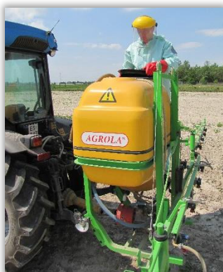
Rys. 13. Sprawdzenie pokrywy i ścian zewnętrznych zbiornika.
