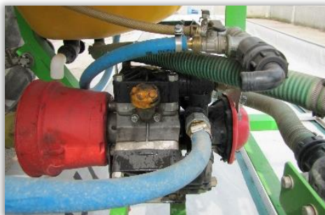
Rys. 15. Pompa przeponowa opryskiwacza.
