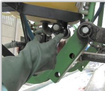
Rys. 33. Zawór spustowy opryskiwacza polowego.
