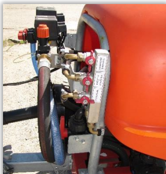
Rys. 106 i 107. Zawory sterujące zasilaniem układu płuczącego (106) i zraszacz we wnętrzu zbiornika opryskiwacza (107).
