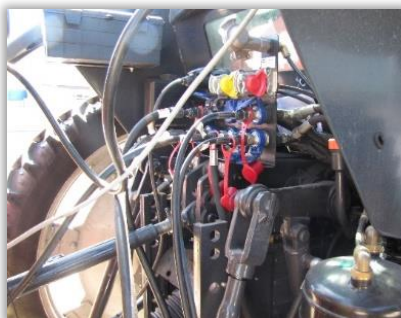
Rys. 7. Sprawdzenie przewodów cieczowych opryskiwacza.
