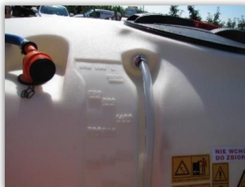
Rys. 97. Skala zbiornika opryskiwacza sadowniczego wyrażona w galonach i litrach z wskazaną pojemnością nominalną.
