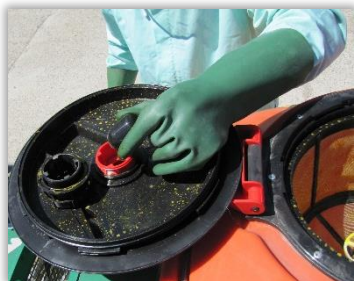
Rys. 100 i 101. Pokrywa zbiornika opryskiwacza z systemem napowietrzającym.
