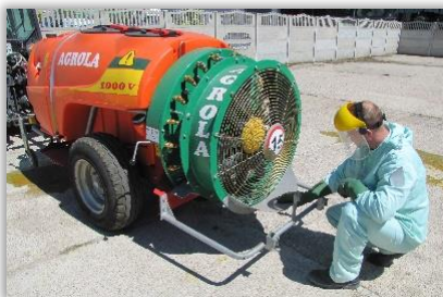
Rys. 92 i 93. Ocena czystości wentylatora opryskiwacza sadowniczego.
