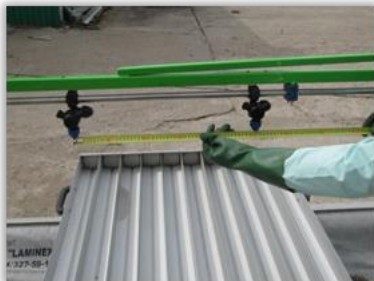
Rys. 70. Pomiar odległości między rozpylaczami zainstalowanymi na belce połowej opryskiwacza połowego za pomocą przymiaru wstęgowego.
