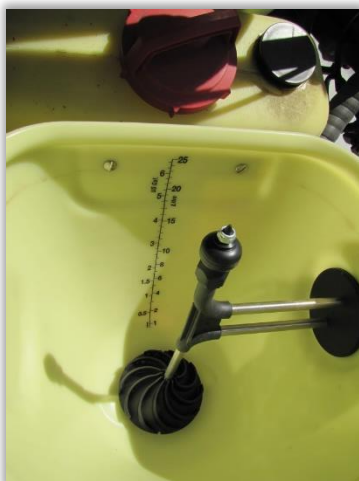
Rys. 46 i 47. Płuczka opakowań po środkach ochrony montowana w rozwadniaczu bocznym opryskiwacza (46) i test płuczki (47).
