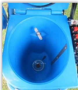
Rys. 43 i 44. Sito we wnętrzu rozwadniacza zatrzymujące przedmioty o wymiarach większych niż 20 mm.
