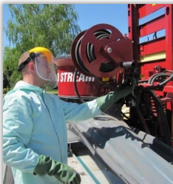
Rys. 37. Zawory włączające funkcje układu cieczowego.
