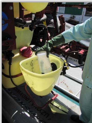
Rys. 46 i 47. Płuczka opakowań po środkach ochrony montowana w rozwadniaczu bocznym opryskiwacza (46) i test płuczki (47).
