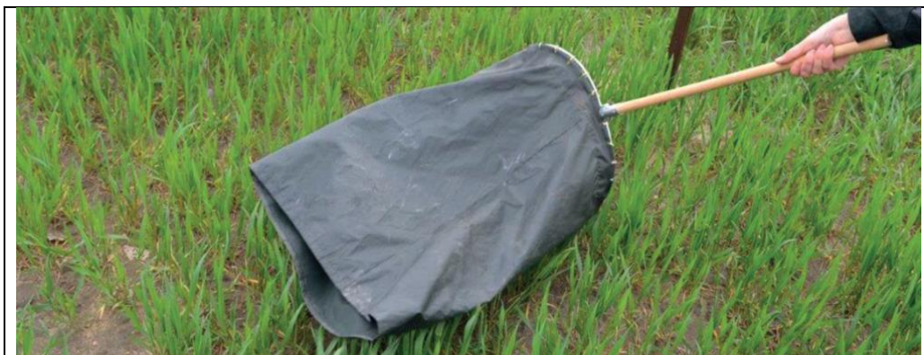
Fot. 6. Czerpak entomologiczny używany do odłowu entomofauny.
