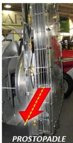
Opryskiwacz deflektorowy z ustawną szczeliną powietrza
