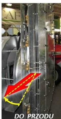
Opryskiwacz deflektorowy z ustawną szczeliną powietrza
