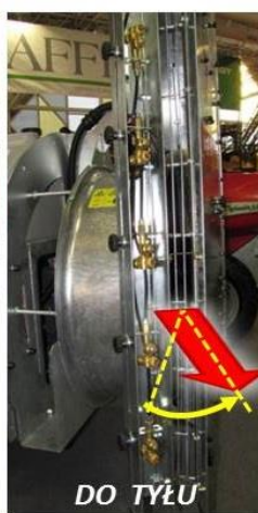
Opryskiwacz deflektorowy z ustawną szczeliną powietrza
