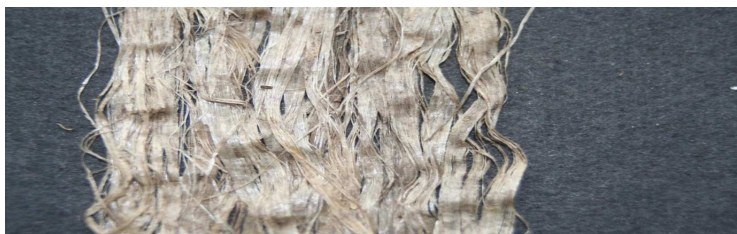
Fot. IX. 3.6.1 Włókno ze słomy należycie wyroszonej (tasiemka dzieląca się - zawartość paździerzy do 9 %) (Fot. K. Heller)
