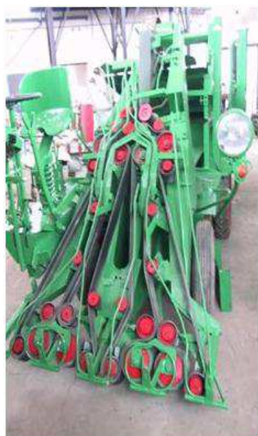
Fot. IX.2.4 Samobieżna wyrwywaczka do lnu – Czechy (Fot. K. Heller).
