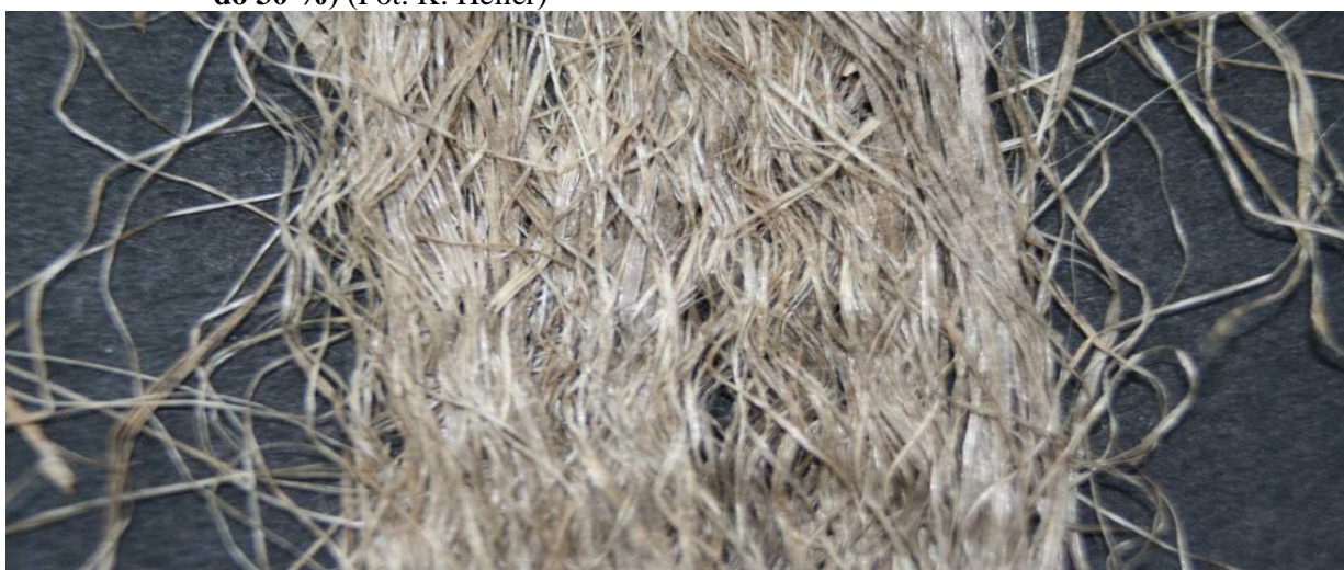
Fot. IX.3.7. 4. Włókno ze słomy przeroszonej (tasiemka rozbita - zawartość paździerzy do 15 %) (Fot. K. Heller)
