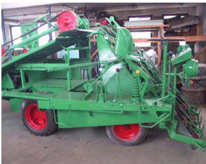
Fot. IX.2.4 Samobieżna wyrwywaczka do lnu – Czechy (Fot. K. Heller).
