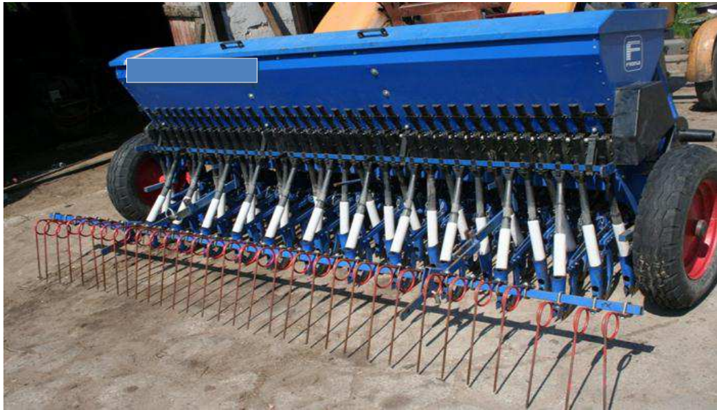
Fot. II. 6.3.1 Siewnik do siewu lnu włóknistego umożliwia wykonanie siewu pasowego (fot. K. Heller)
