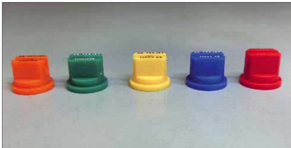
Fot. 52. Zgodnie z normami ISO kolor rozpylacza koduje jego wydajność cieczy w ciągu 1 minuty. Rozpylacze o większym wypływie cieczy wytwarzają krople o większych rozmiarach, gdy pracują pod tym samym ciśnieniem (fot. H. Ratajkiewicz)
