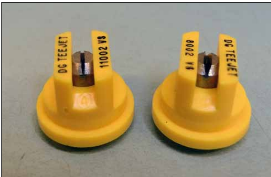
Fot. 57. Rozpylacze różniące się kątem strumienia kropli, 110° po lewej i 80° po prawej różnią się ukształtowaniem (szerokością) szczeliny wylotowej, co skutkuje wytwarzaniem nieco większych kropli przez rozpylacz o węższym strumieniu (fot. H. Ratajkiewicz)
