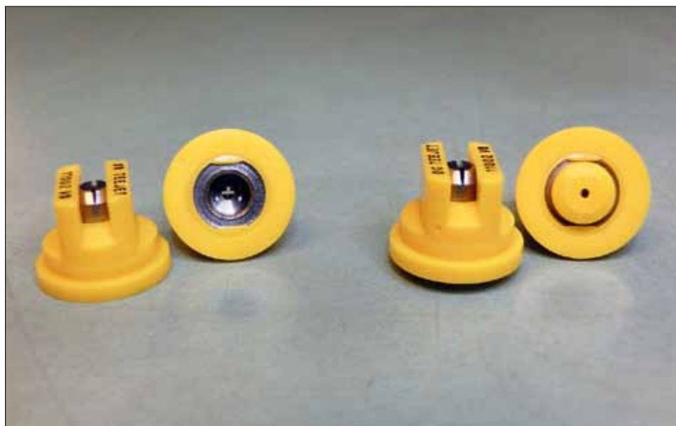
Fot. 56. Rozpylacz wyposażony w kryzę wstępną (po prawej) wytwarza krople większe i mniej podatne na znoszenie niż rozpylacz klasyczny (po lewej), mimo że ukształtowanie szczeliny wylotowej jest takie samo (fot. H. Ratajkiewicz)
