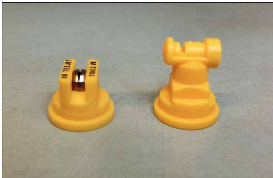
Fot. 55. Rozpylacz strumieniowe: klasyczny (po lewej) i uderzeniowy (po prawej) różnią się charakterystyką wytworzonych kropli, gdy pracują pod tym samym ciśnieniem cieczy. Dla 0,3 MPa, pierwszy klasyfikowany jest jako drobnokroplisty, drugi średniokroplisty (fot. H. Ratajkiewicz)
