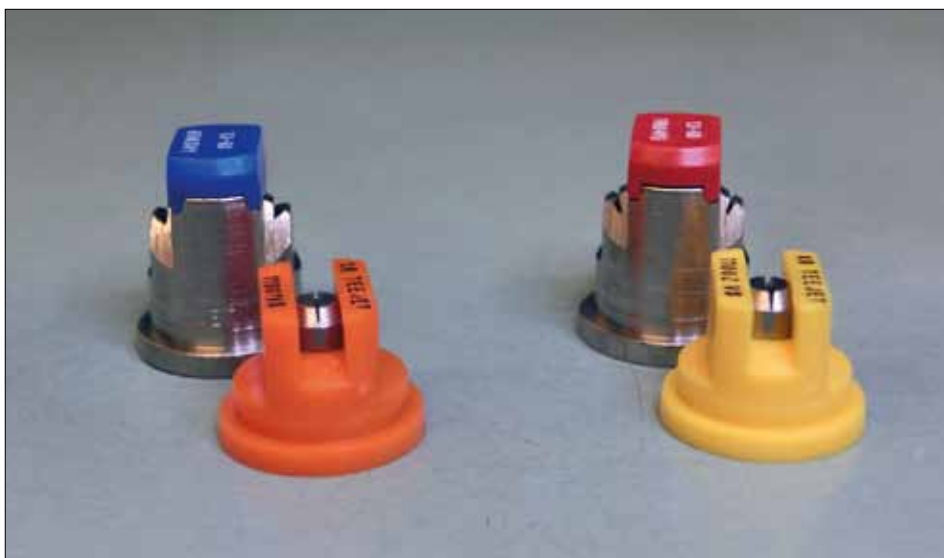
Fot. 54. Dwa strumienie cieczy w rozpylaczu dają możliwość uzyskania odpowiednio mniejszych kropli w porównaniu do jednego strumienia przy tym samym wypływie cieczy. Rozpylacze przedstawione na zdjęciu klasyfikowane są jako drobnokropliste, gdy ciśnienie cieczy wynosi 0,3 MPa, jednak rozpylacze znajdujące się po lewej stronie wytwarzają krople drobniejsze niż odpowiadające im typem rozpylacze po prawej stronie (fot. H. Ratajkiewicz)
