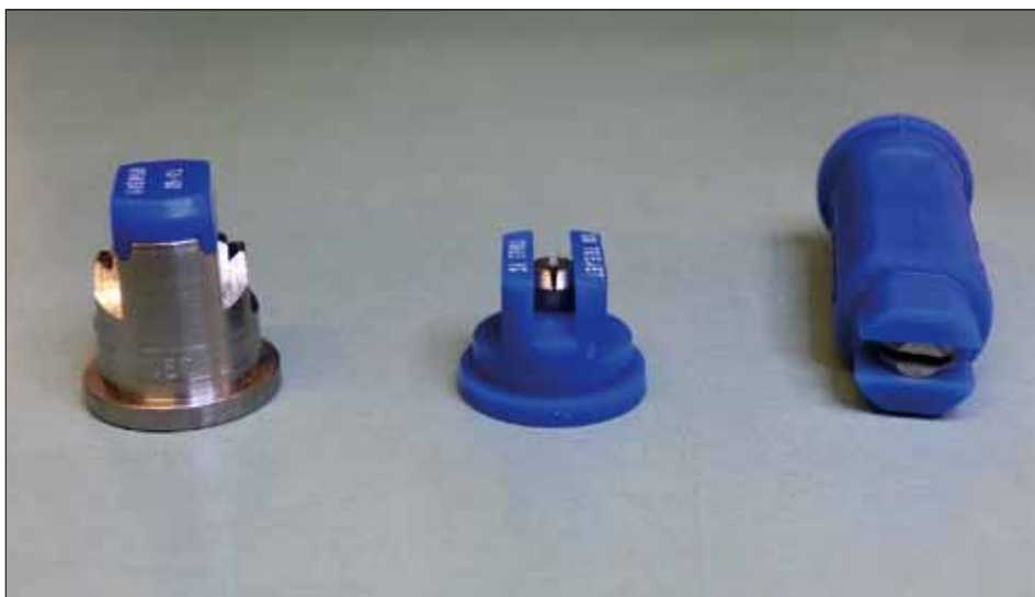
Fot. 53. Wielkość kropli wytwarzana przez rozpylacz o płaskim strumieniu zależy od jego konstrukcji. Przy tym samym wydatku i pod ciśnieniem 0,3 MPa rozpylacze przedstawione na zdjęciu klasyfikowane są następująco: bardzo drobnokroplisty – klasyczny rozpylacz dwustrumieniowy (po lewej), drobnokroplisty – klasyczny rozpylacz jednostrumieniowy (w środku), bardzo grubokroplisty – rozpylacz eżektorowy (po prawej) (fot. H. Ratajkiewicz)
